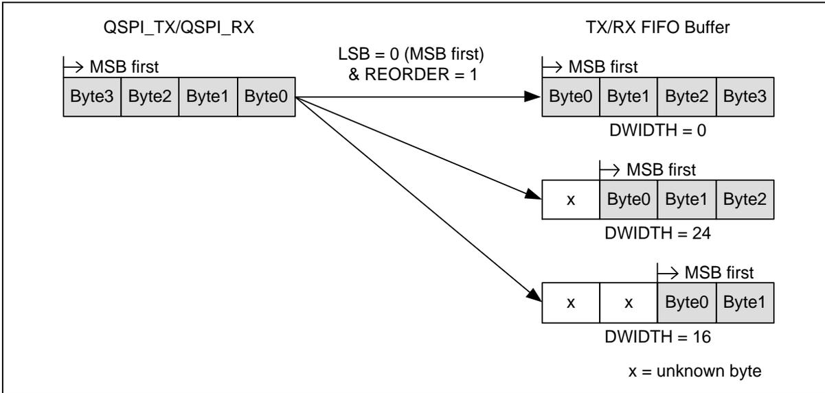
Figure 6.18-8 Byte Reorder Function
