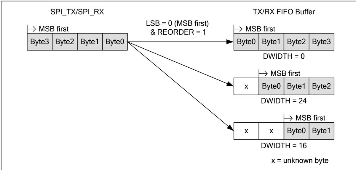
Figure 6.17-8 Byte Reorder Function
